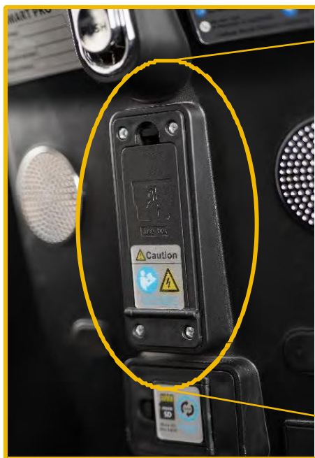
Figur 21 – Plassering av sikringsboksen
