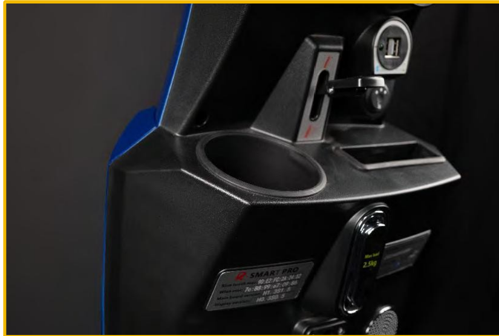
Figur 17 – Koppholder og mobiltelefonholder montert på roret
