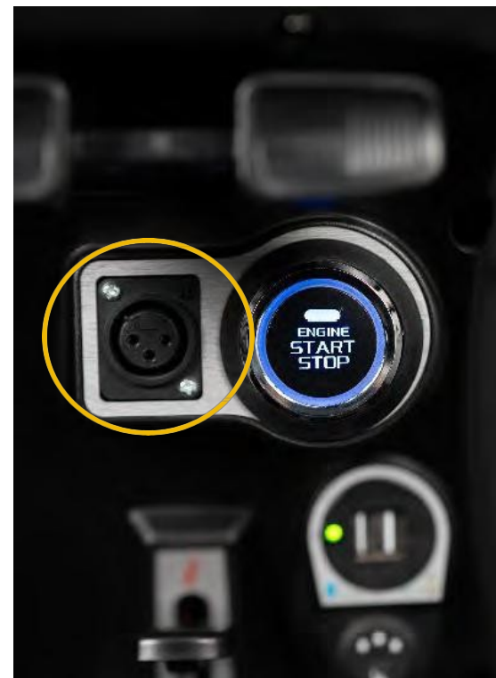
Kuva 19 – Ohjaustankoon asennettu latausportti
