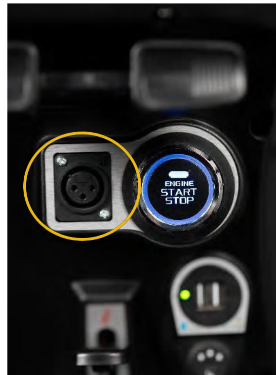
Figur 19 – Ladeport monteret på styret
