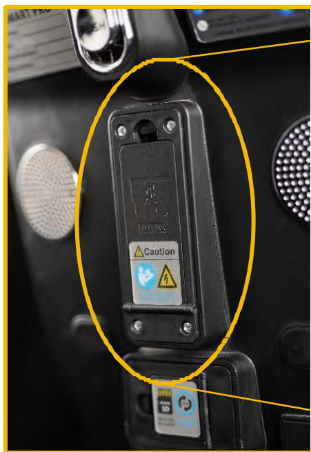
Figur 21 – Plassering av sikringsboks
