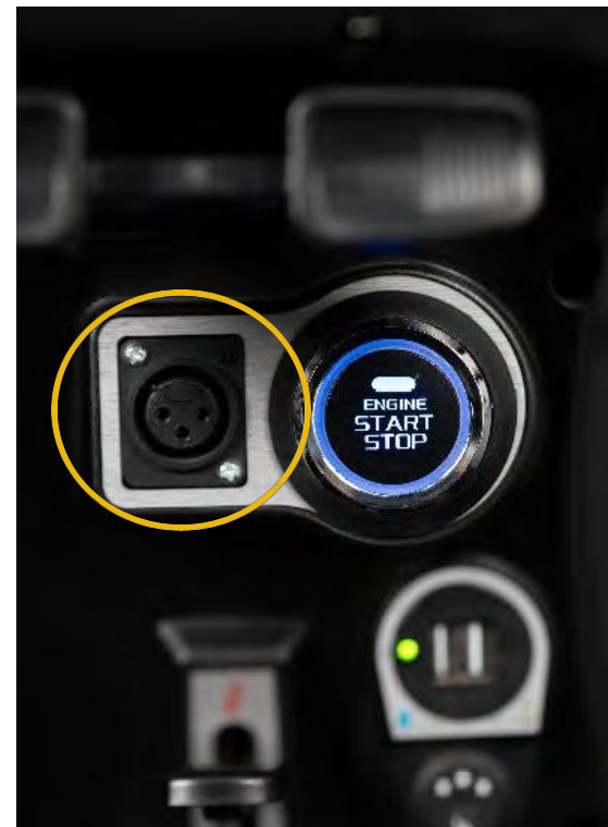
Figur 19 – Ladeport montert på styret
