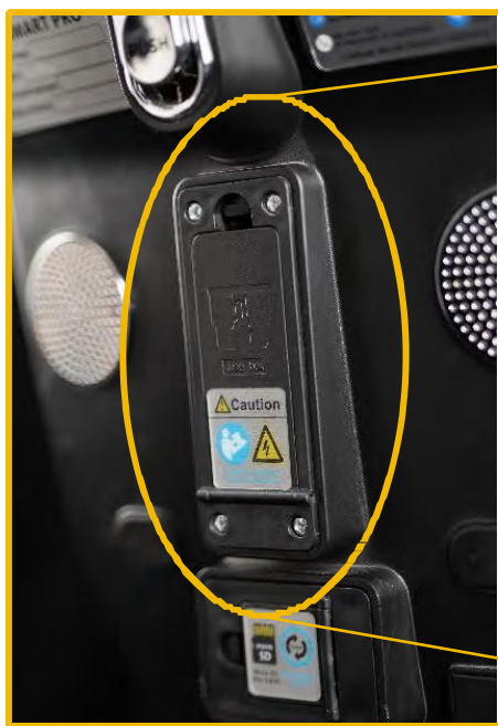
Figur 21 – Placering af sikringsboks
